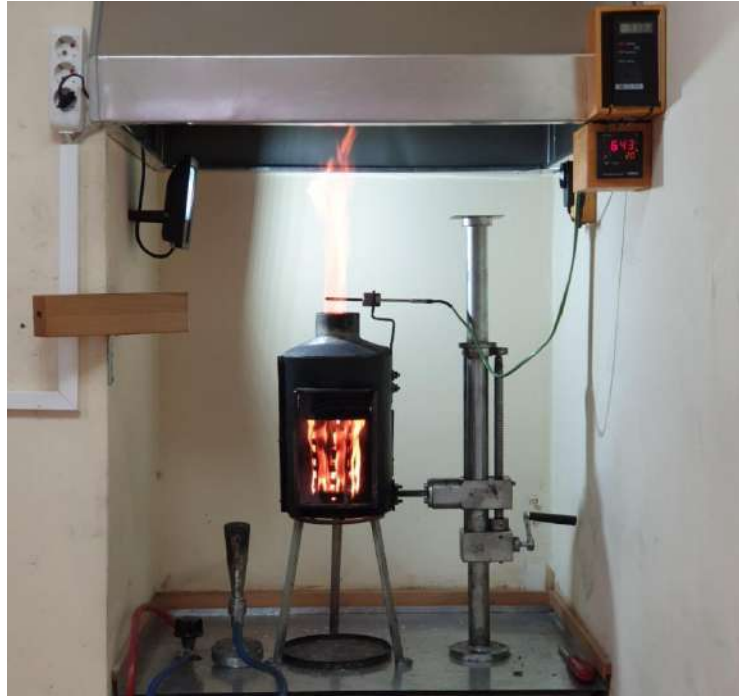
Şekil 1. Yanma test cihazı (KKY aşaması)
