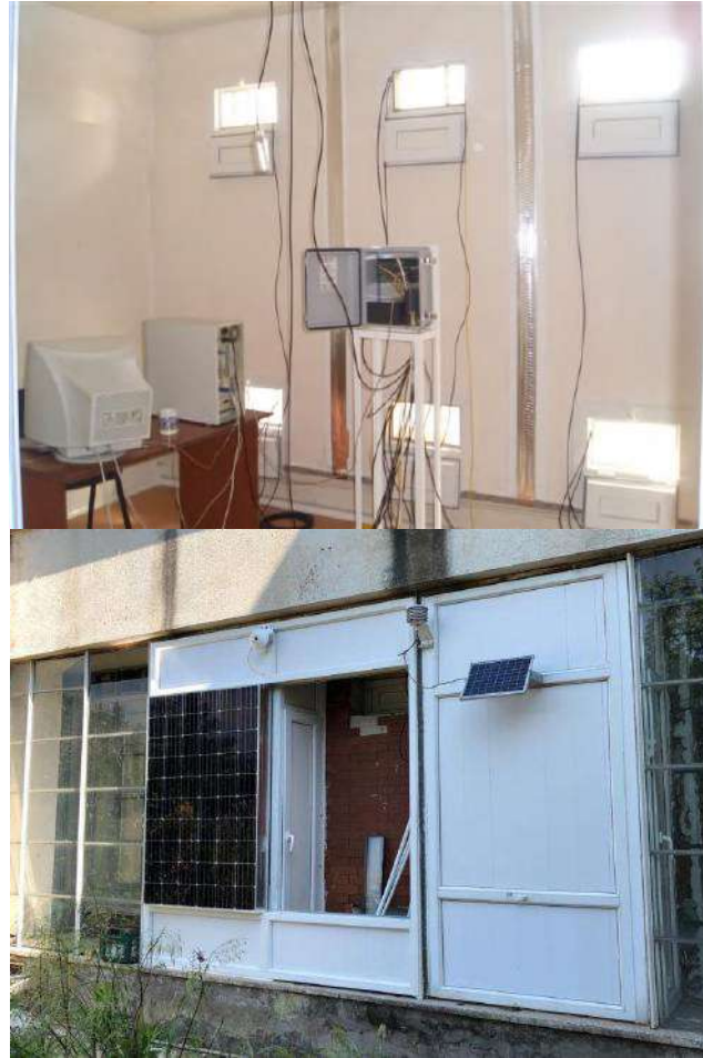
Şekil 9. İç ve Dış ortam sıcaklık ve nem ölçer ile güneş ışınımı ölçerin yerleşimi
