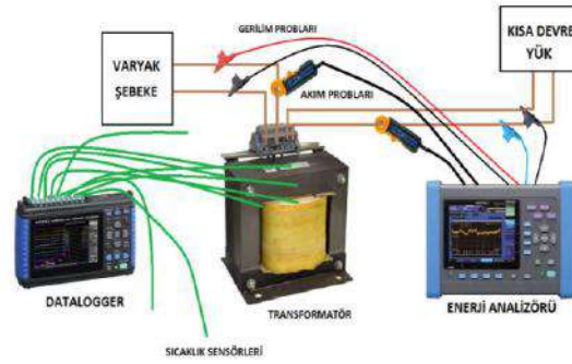
Şekil 1. Deney donanımları ve ölçüm sisteminin bağlantısı
