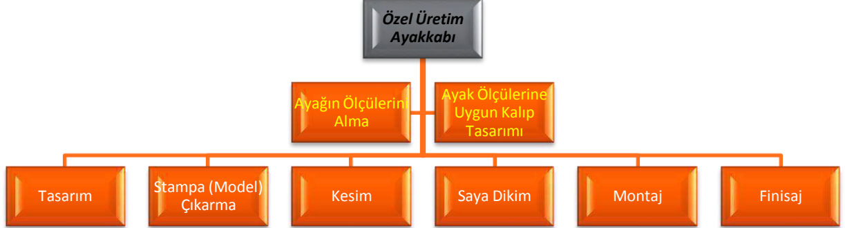
Şekil 2 Özel Üretim Ayakkabı Aşamaları
