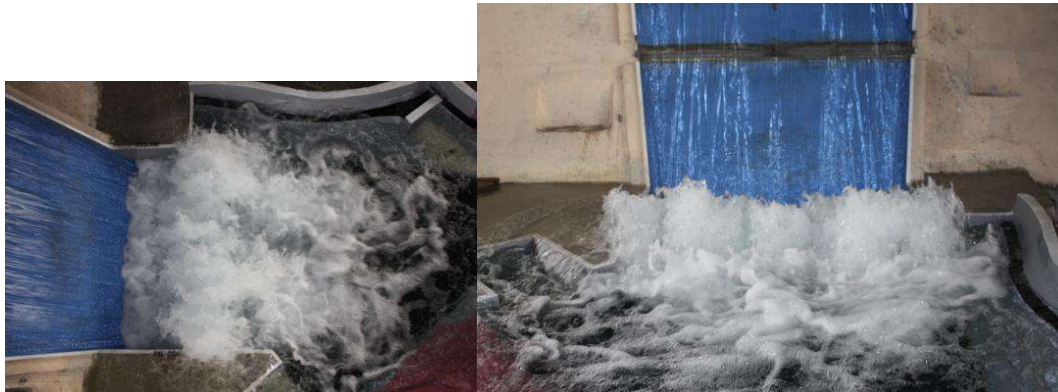
Şekil 6. Fiziksel model çalışmalarından görüşler ( Q=5223 \text{ m}^3/\text{s} , \text{Ö: } 1/60 )
