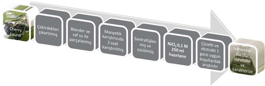
Şekil 1. NiO nanopartikül yeşil sentez prosedürü
