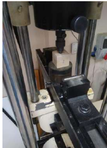
Şekil 1. Janka sertlik deneyinin yapılışı
