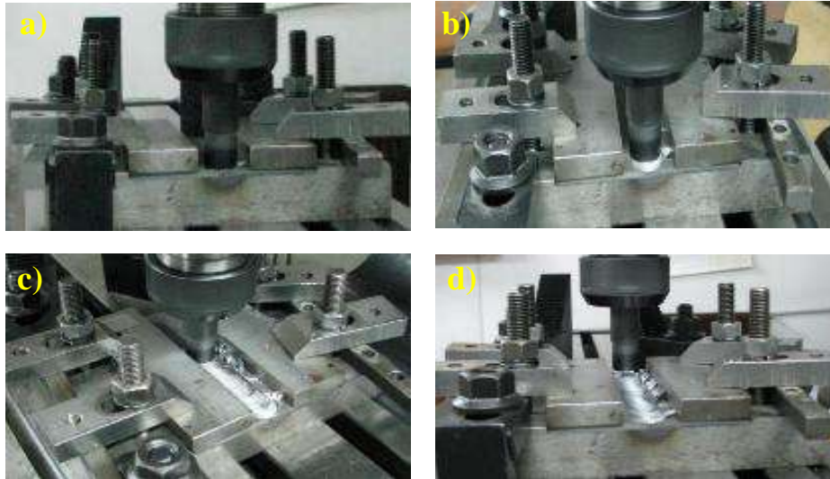
Şekil 8. SKK işlemi, a) SKK öncesi levha ile temas halindeki karıştırıcı uç, b) Karıştırıcı uç ve omuzun temastan kaynaklanarak ısı oluşturması c) SKK işleminde plastik şekil değişimi d) SKK işleminin sona ermesi [8].
