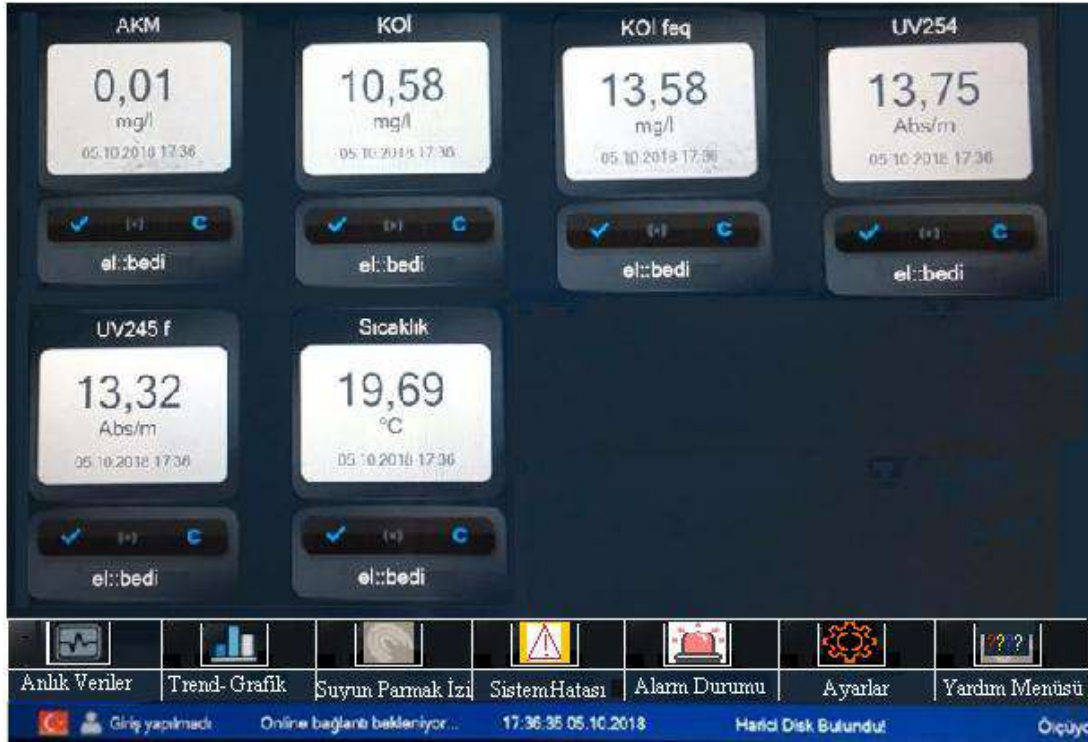
Şekil 2. Farklı tip ve ölçüm tekniğine sahip sensörlerden veri okunması
