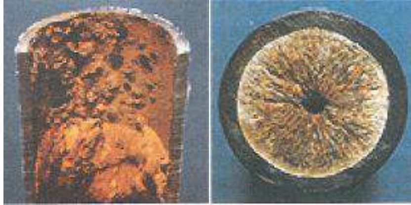
Şekil 5. Metal boruda korozyon ve kabuklaşma
