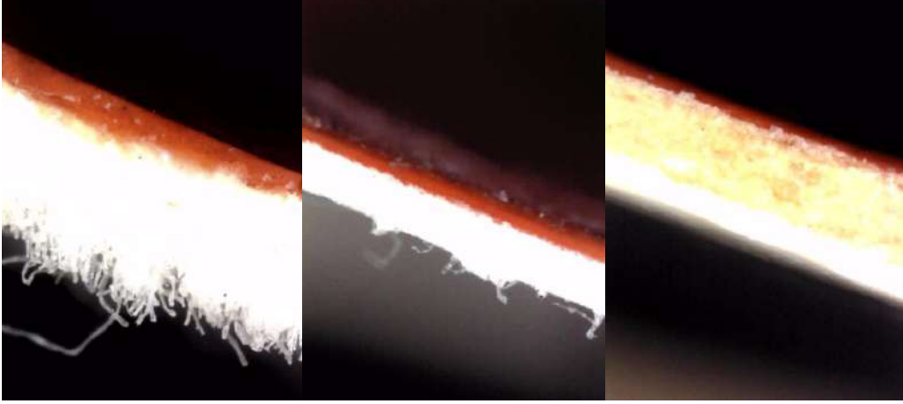
Şekil 7. Sırasıyla tuval bezi, resim kâğıdı ve Bristol kartonun Cadmium Red Hue boya ile boyanmış malzeme-boya ara yüzeyinin stereoskopik mikroskop görüntüleri.
