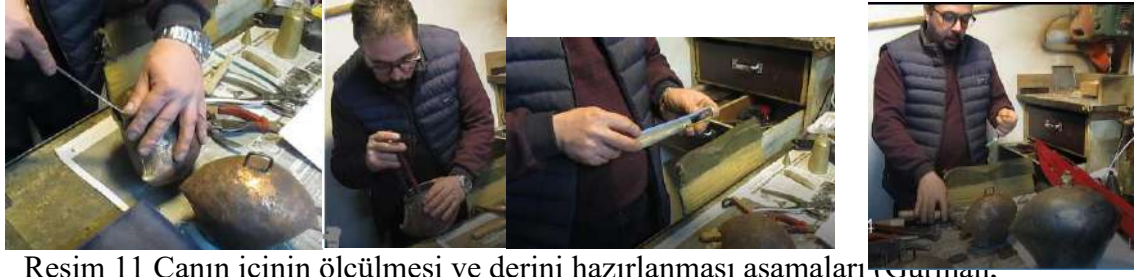
Resim 11 Çanın içinin ölçülmesi ve derini hazırlanması aşamaları (Gürman, Afyonkarahisar 2020).
