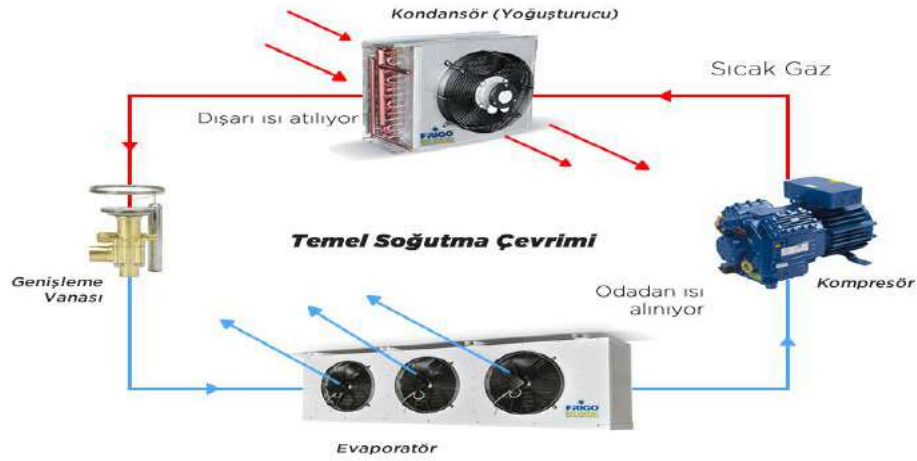
Şekil 1. Temel Gazlı Soğutma Çevrimi Şeması
